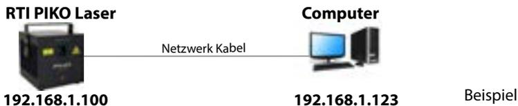
Die RTI PIKO Showlaser Serie haben standardmäßig die IP Adresse 192.168.1.100 eingestellt. Um die Verbindung herzustellen und die IP Adresse zu konfigurieren, muss das Lasersystem über ein Ethernet-Kabel direkt mit dem Laptop oder PC verbunden werden.
